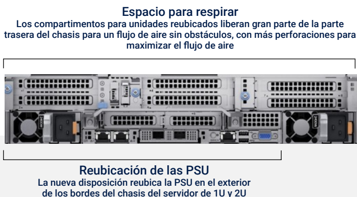
Figura 1 | Los elementos de diseño físico pueden ayudar a reducir el consumo de energía al permitir que el aire fluya y refrigere los componentes del servidor
